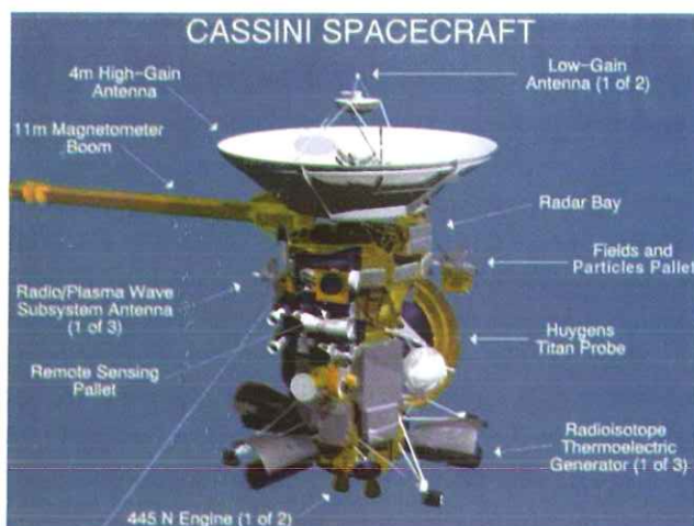
Figura 1 Il veicolo spaziale della missione Cassini: al centro seminascosto si intravede il posizionamento della sonda Huygens che verrà rilasciato nella atmosfera di Titano.
